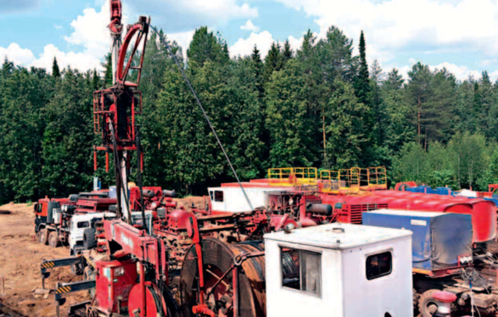
Рисунок 1 – Проведение работ по технологии Plug&Perf на месторождении ООО «Башнефть-Добыча»
