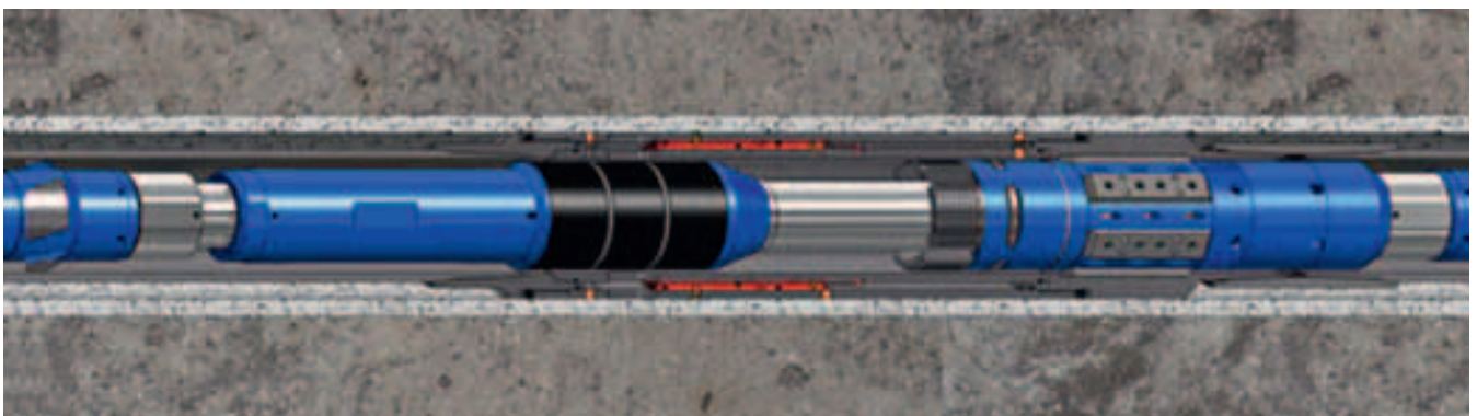
Рисунок 7 – Расположение активационного ключа для открытия/закрытия муфты ГРП
